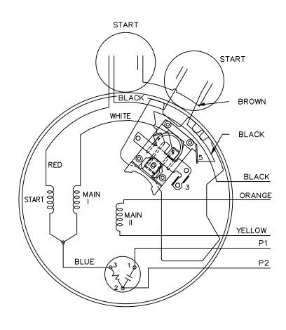
DUAL VOLTAGE CAPACITOR START OVERLOAD — CW FIXED
